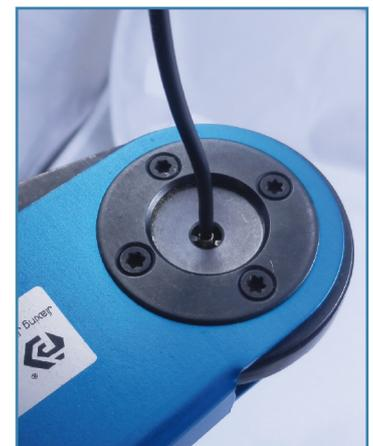
Si esegue la crimpatura, al termine della quale la pinza si riapre ed e' possibile estrarre il contatto crimpato per eseguire i controlli del caso.
