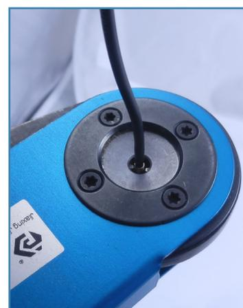
Si esegue la crimpatura, al termine della quale la pinza si riapre ed e' possibile estrarre il contatto crimpato per eseguire i controlli del caso.
