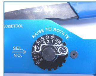
Occorre poi regolare la profondita' del foro di crimpatura a seconda del size del contatto e del tipo (maschio o femmina), utilizzando la regolazione a vite, fino ad ottenere il corretto posizionamento del contatto (Figura 6).
